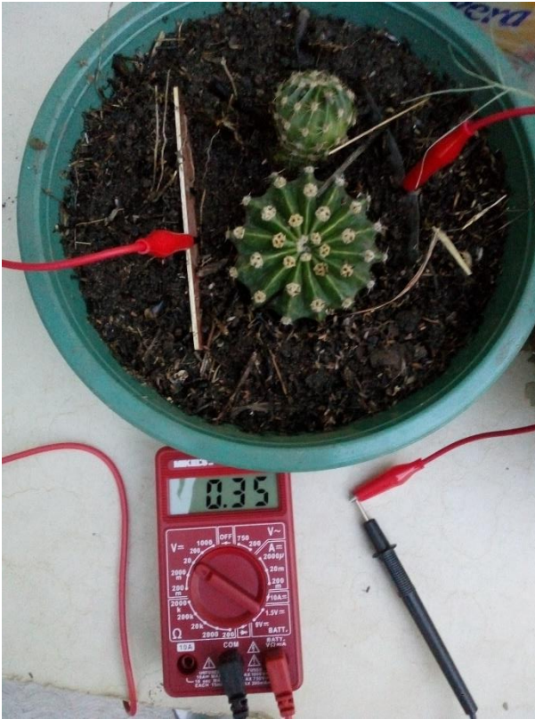
Figura 2. Método de medición de la energía. (Cactácea en tierra de maceta o huizache)
