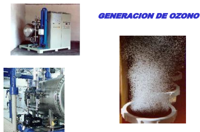
Ilustración 2. Equipo industrial para producción de ozono y difusores de burbuja fina para inyección del aire rico en ozono.
