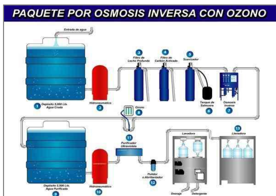
Figura 1. Proceso osmosis inversa con ozono (Utilizado por los locales)
